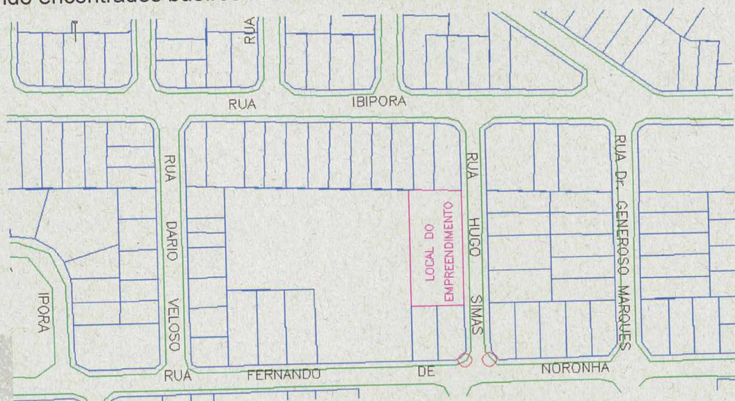
Figura 07: Croqui esquemático da localização das bocas de lobo nas ruas de entorno do empreendimento – circulo vermelho representa as bocas de lobo encontrados.
