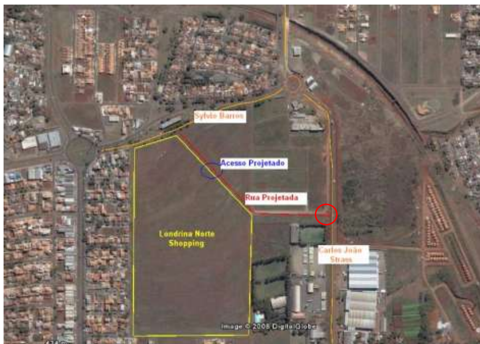
Figura 55: Proposta de acesso ao empreendimento - Via F – Sentido Norte – Centro, via Carlos João Strass ( Linha Laranja ), utilizando-se da rotatória e vias projetadas ( Linha vermelha ).
