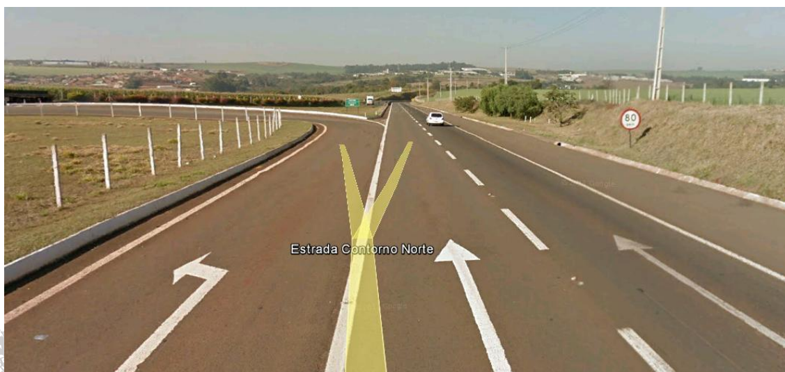
Figura 40: Sinalização vertical de limite de velocidade e horizontal de conversões existentes na Estrada do Contorno Norte.
