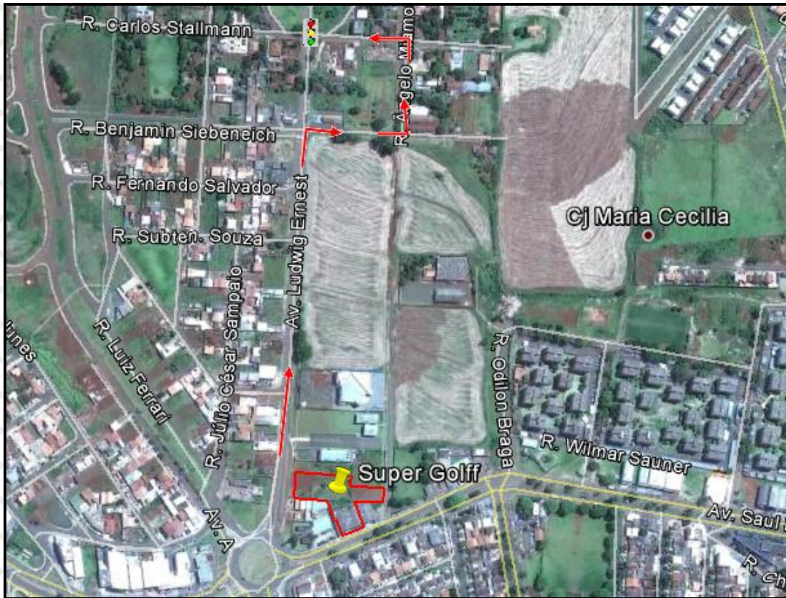
Figura 14: Sugestão de instalação de semáforo no cruzamento da Av. Ludwig Ernest com a Rua Carlos Stallmann acompanhados de placas de trânsito e sinalização horizontal e vertical. Fonte: Adaptado de Google Earth, 2012.
