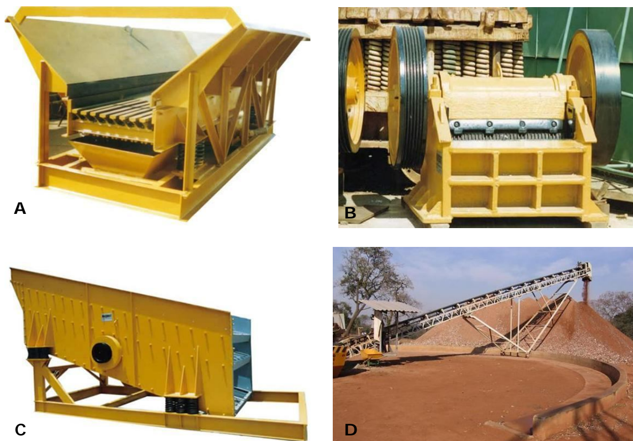
Figura 01: Equipamentos comumente utilizados em usinas de reciclagem de resíduos de construção civil: (A) Alimentador vibratório; (B) Britador; (C) Peneira vibratória e (D) Transportador de correias.
