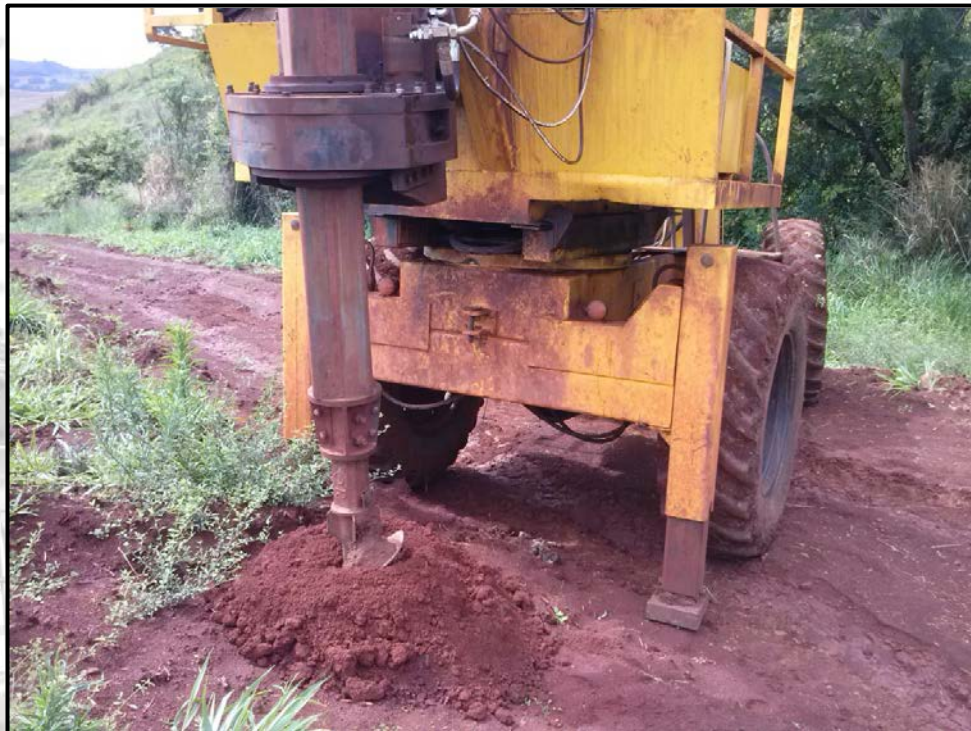
Figura 05: Trado utilizado para as sondagens. Fonte: Brasil Ambiental, 2013.
