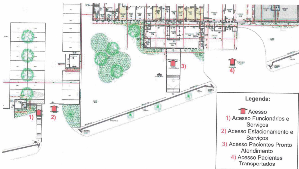
Figura 17: Acesso à ampliação do hospital.
