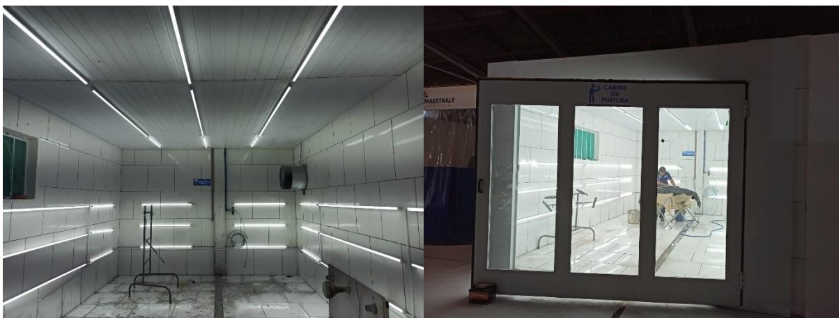
Figura 06: Foto cabine de Pintura modelo utilitário em alvenaria Fonte: Gustavo da Silva, 2021
