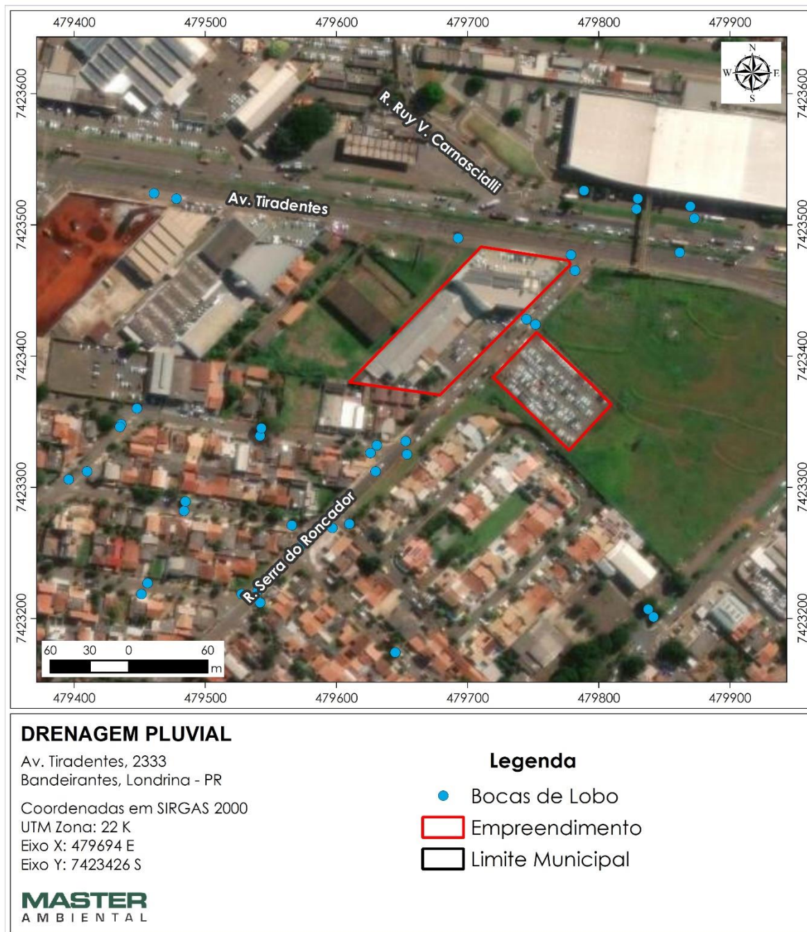
Figura 44: Drenagem pluvial no entorno do empreendimento.
