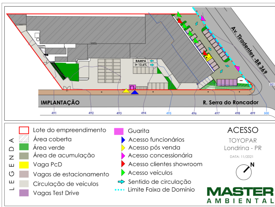
Figura 71: Acessos ao empreendimento e área de acumulação, Lote nº 9-C/10-C-1.
