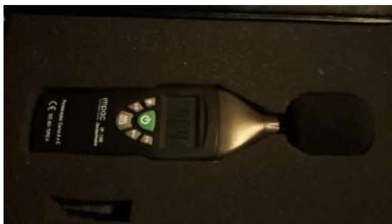
Equipamento utilizado para medição de ruído
