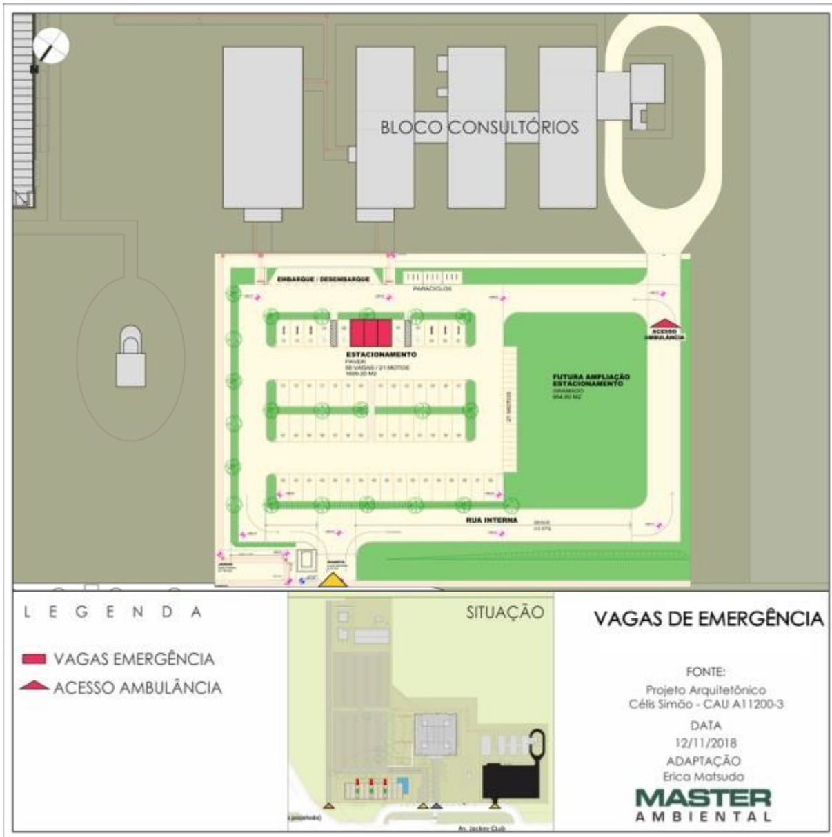
Figura 98: Acesso Vagas de Emergência. Fonte: Projeto Arquitetônico.
