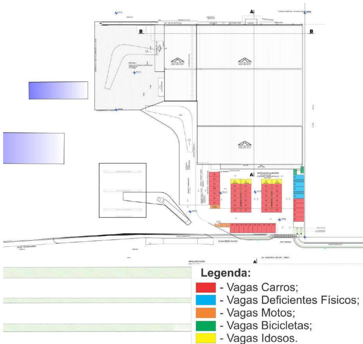
Figura 64: Disposição do estacionamento no empreendimento – Térreo
