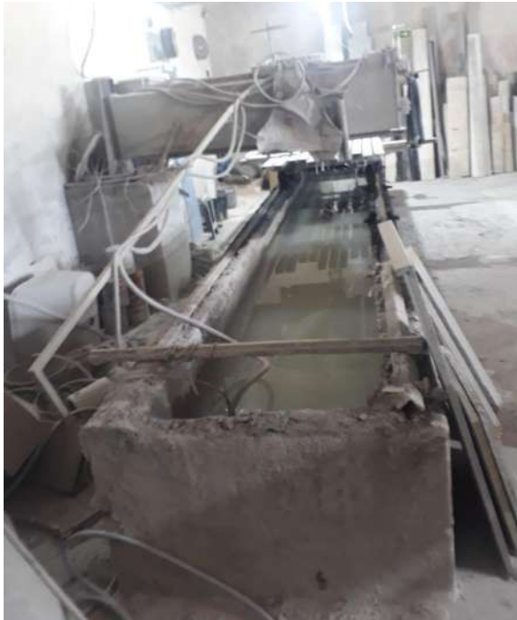
Figura 24: Tanque de corte com serra circular em úmido.
