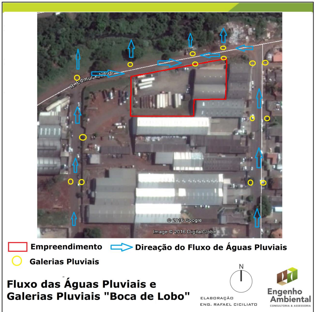
Figura 18: Fluxo das águas pluviais e galerias pluviais "boca de lobo" Fonte: Autor, 2017.
