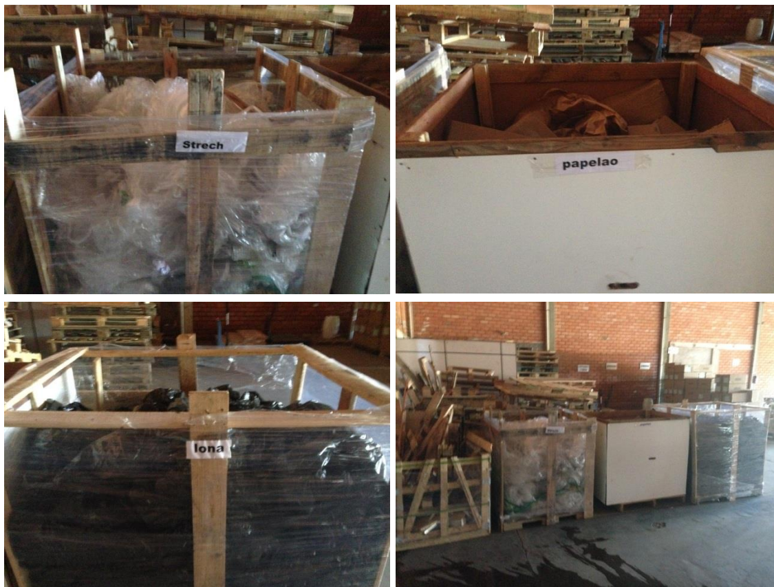
Figura 92: Recipientes para a segregação e armazenamento dos resíduos sólidos
