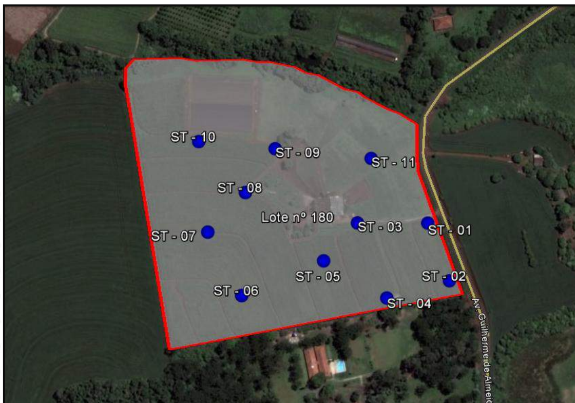
Figura 06: Localização dos furos para sondagem do solo. Fonte: Google Earth (modificado Brasil Ambiental, 2013).
