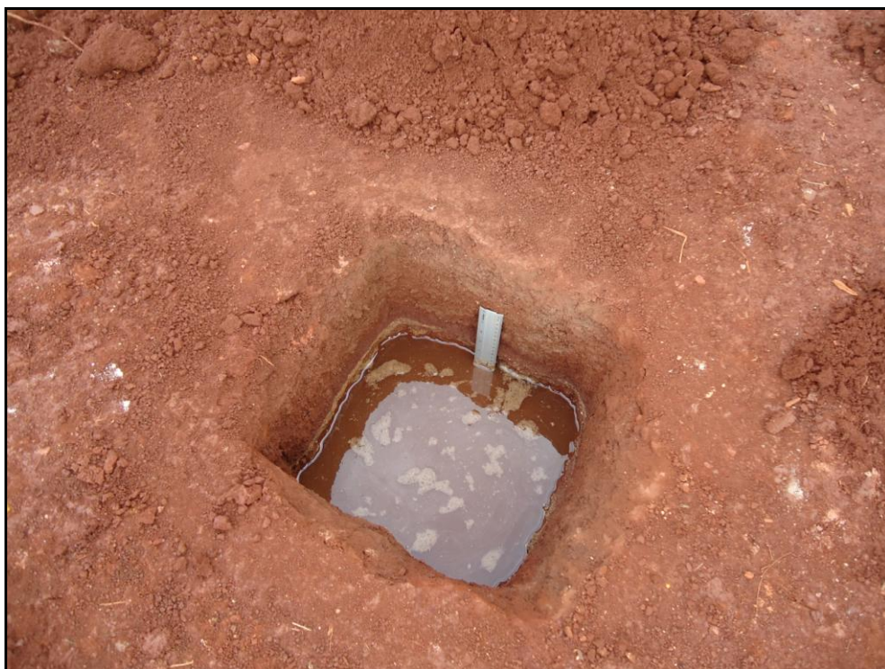
Foto 2 – Rebaixamento do nível de água durante teste de percolação
