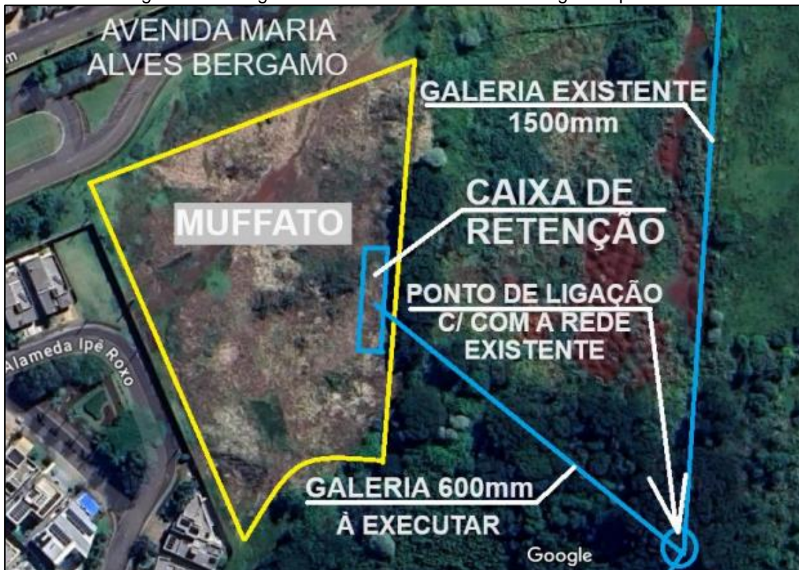
Figura 21 – Imagem aérea do dimensionamento da galeria pluvial.
