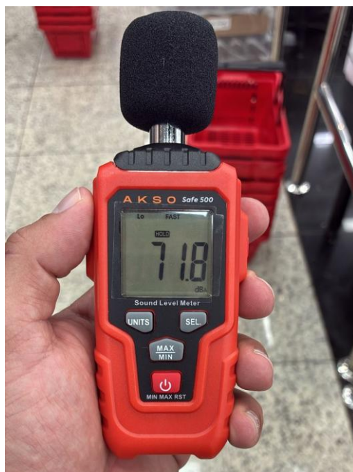
Figura 6: Medições de ruídos realizadas no interior de loja da rede de porte similar. Fonte: O Autor 2025
