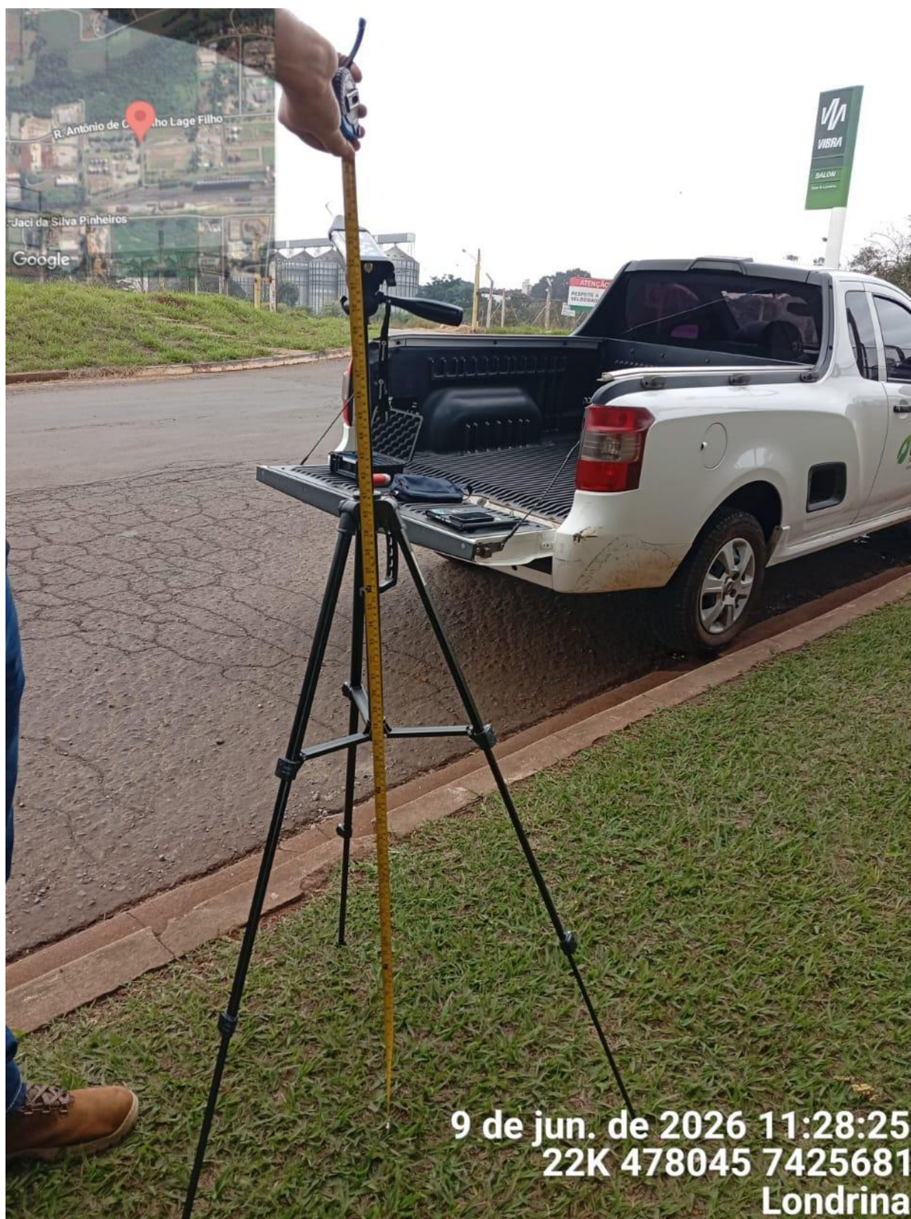
Figura 3. Registro da medição do tripé em relação ao solo
