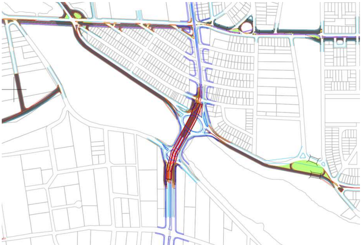
Figura 69: Estudo de traçado viário – Obra Av. Maringá x Av. Ayrton Senna da Silva x Rua Prof. Joaquim de Matos Barreto
