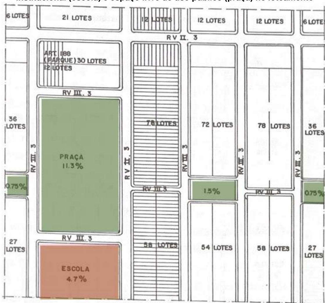
Figura 23 – Representação de área de implantação de equipamento comunitário (área institucional (escola) e espaço livre de uso público (praça) no loteamento
