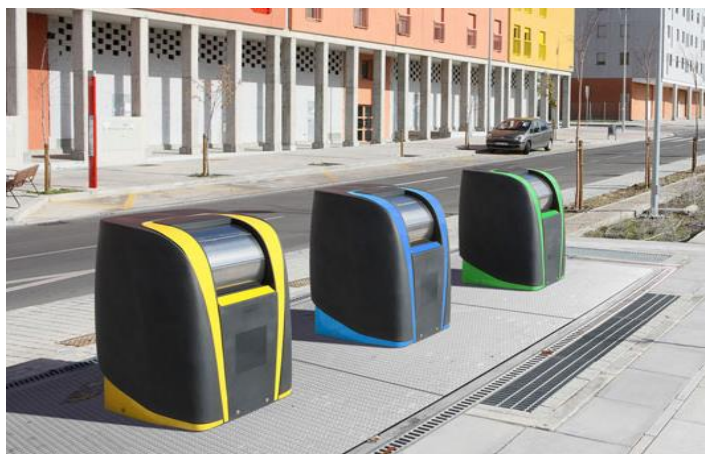
Figura 28: Contêineres laterais enterrados
