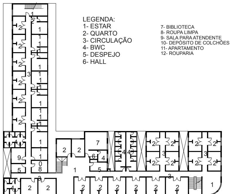
PLANTA SEGUNDO PAVIMENTO
