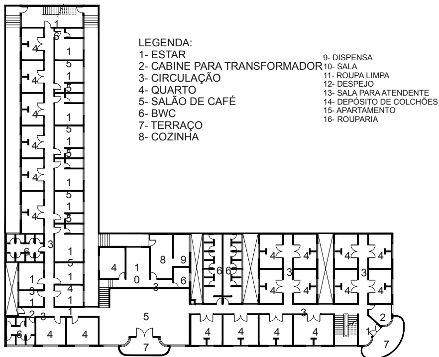
PLANTA PRIMEIRO PAVIMENTO
