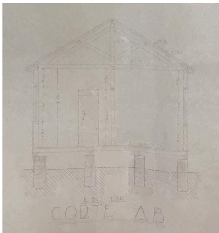
Corte AB residência, 1945 (demolido).
