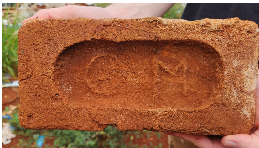
Tijolo cerâmico maciço retangular utilizado na construção da Chaminé. Fonte: Autores (2024).
