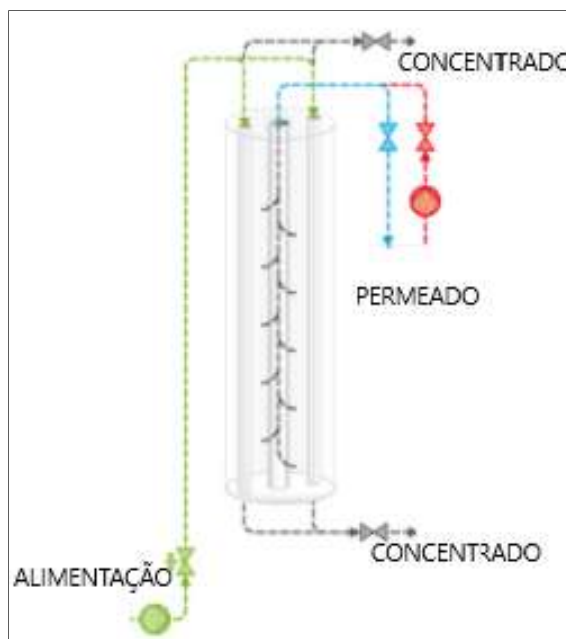
Figura 39 – Esquema de funcionamento do sistema de ultrafiltração
