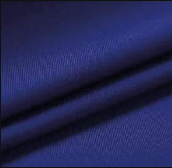
T11. SARJA Contextura: tecido plano Construção: sarja Gramatura: 200 g/m2 Largura: 1,60m Composição: 100% algodão (CO)
