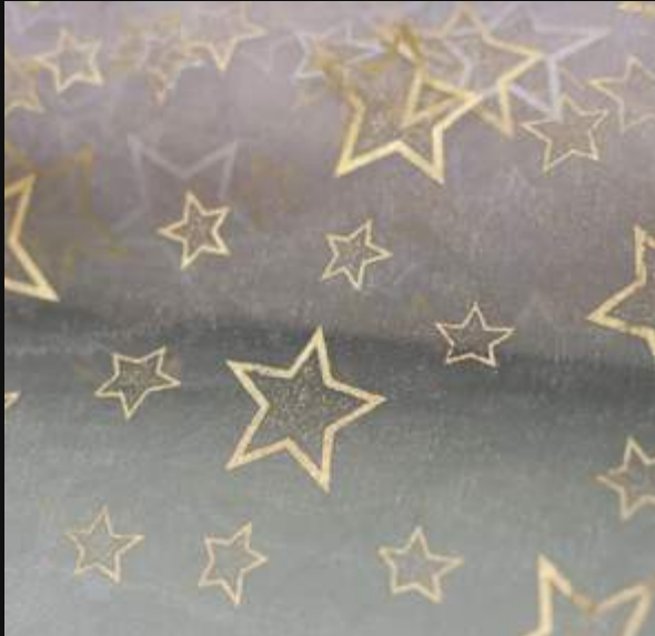
T8. ORGANZA ESTAMPADA Contextura: tecido plano Construção: tela Gramatura: 84 g/m2 Largura: 1,30m /kg Composição: 100% poliéster (PES)
