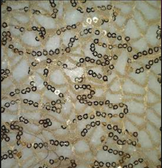
T9. RENDA COM PAETÊ Contextura: malha Construção: malha hexagonal Gramatura: 70 g/m2 Largura: 1,50m Composição: 100% poliéster (PES)
