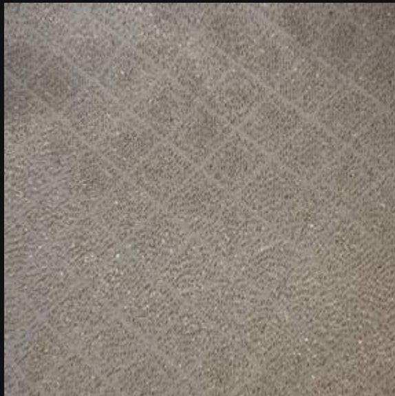
T6. MALHA LUREX Contextura: malha Construção: malha Gramatura: 70 g/m2 Largura: 1,50m Composição: 100% poliéster (PES)
