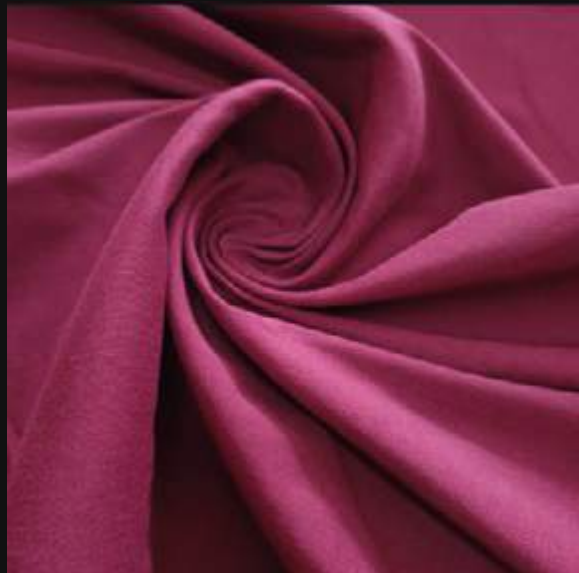
T1. BENGALINE Contextura: tecido plano Construção: cetim Gramatura: 140 g/m2 Largura: 1,47m Composição: 96% algodão (CO) 3% elastano (PUE) 1% poliéster (PES)
