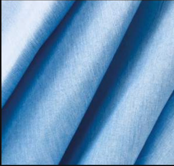
T10. SARJA DENIM Contextura: tecido plano Construção: sarja Gramatura: 165 g/m2 Largura: 1,60m Composição: 63% algodão (CO) / 37% poliéster (PES)
