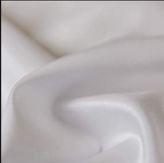
T2. CETIM Contextura: tecido plano Construção: cetim Gramatura: 105 g/m2 Largura: 1,45m Composição: 100% poliéster (PES)
