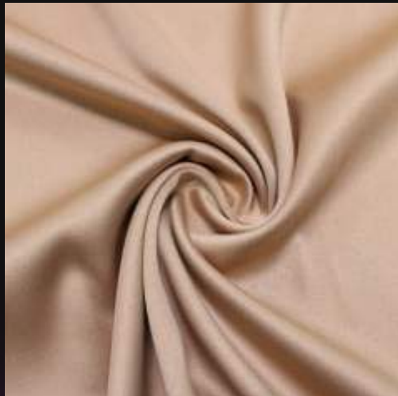
T4. GABARDINE ACETINADO Contextura: tecido plano Construção: sarja Gramatura: 140 g/m2 Largura: 1,50m Composição: 96% poliéster (PES) / 4% elastano (PUE)
