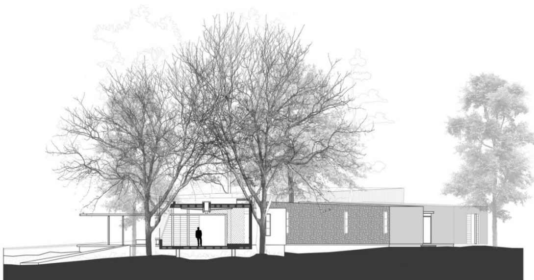
Figura 23 - Corte mostrando a relação do edifício com a topografia
